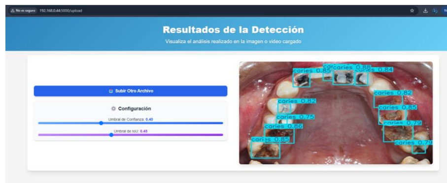
Figura 14. Interfaz del Prototipo YOLOv8 para Detección Automatizada en Imágenes Odontológicas Fuente: Elaboración propia
