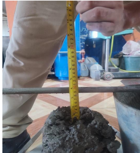
Figura 2: Toma de revenimiento en hormigón base.
