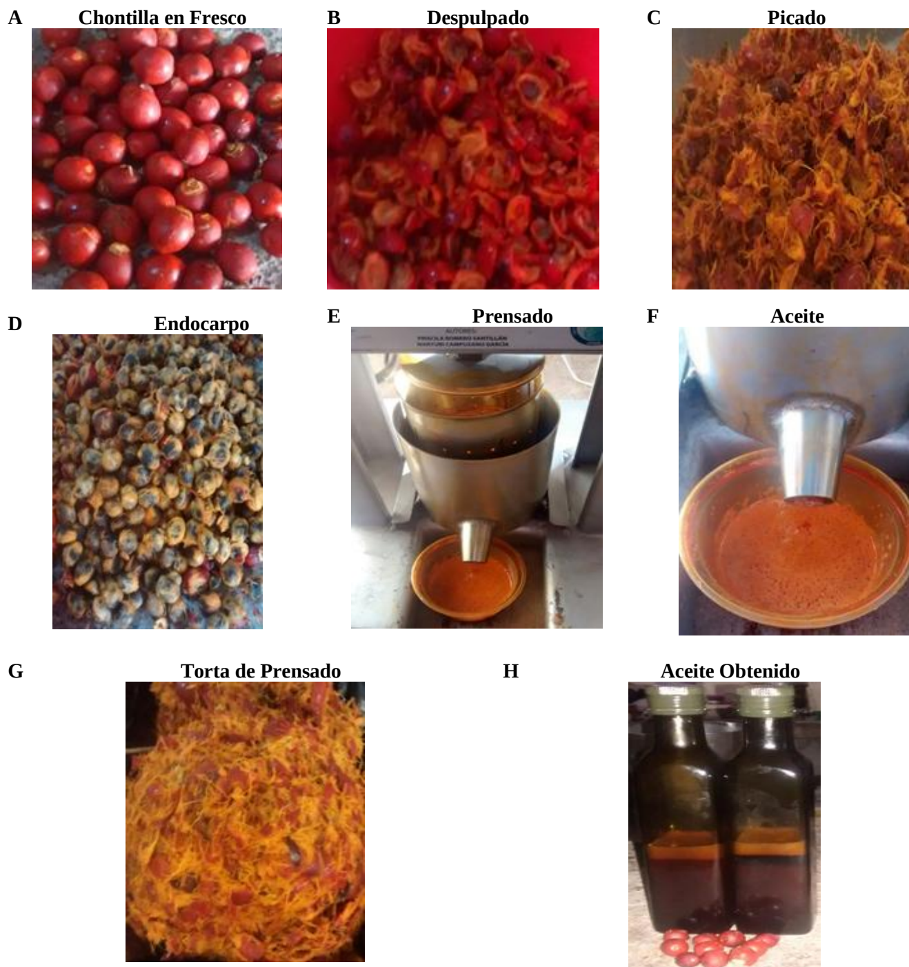
Figura 7. Procedimiento de prensado en frío.
