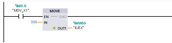
**Figura 9.** Programación Salida Actuador Lineal X.
