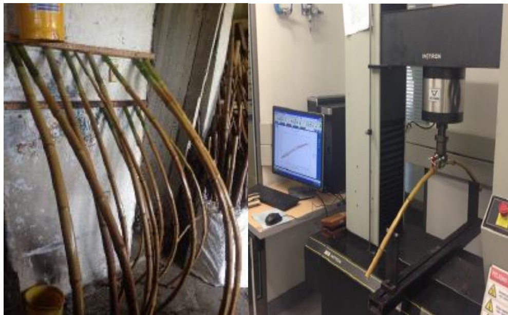
Figura 11. Fijado de forma artesanal - Flexión con máquina universal.
