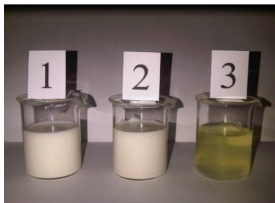
Figura 2. Suero de mantequilla, retenido y permeado obtenidos luego del proceso de MFT
